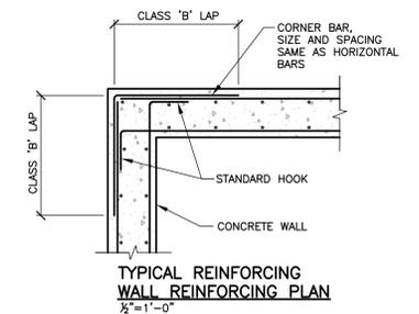
**TYPICAL REINFORCING WALL REINFORCING PLAN**
